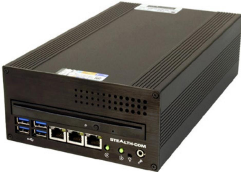
Различия моделей следующие. Stealth LPC-480G4FS – безвентиляторный, использует в качестве радиатора весь кузов ПК из экструдированного алю-
